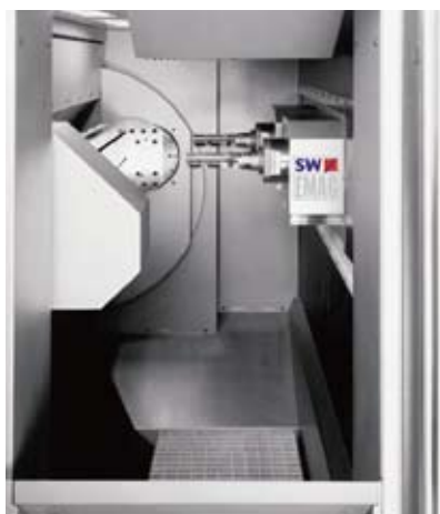
图2 一台双主轴卧式加工中心加工空间
