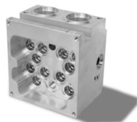
图 8 被加工工件示例——ABS 阀体
